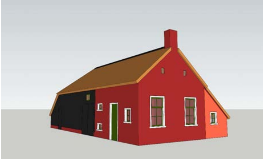
Karakteristiek beeld met veel voorkomende aanpassingen in de negentiende eeuw. Opvallend zijn vooral de aanbouw van een zijkamer, vernieuwing van metselwerk en de wijzigingen aan de gevelopeningen.
